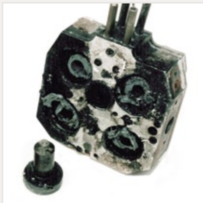
Vorher: Stark verschmutzte Heißkanalkomponenten nach dem Ausbau
