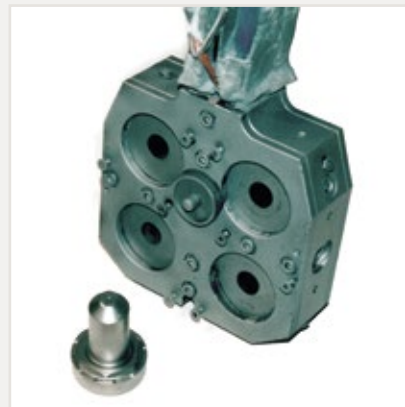
Nachher: Abrasivfreie Reinigung mit dem Softstrahlverfahren, ohne thermische Beanspruchung der Bauteile
