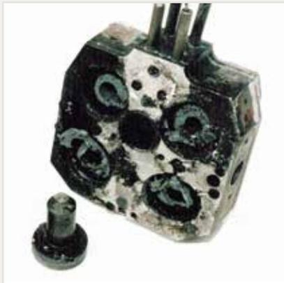
**Vorher:** Stark verschmutzte Heißkanalkomponenten nach dem Ausbau
