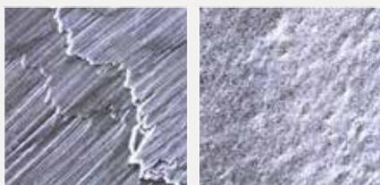
Furchenbildung, Schleifbrand und Schleifscheibenrückstände beim Schleifen oder durch die Fräsbearbeitung entstandene Steps, Schieferbildungen oder Grundmaterialausrisse, beim HSC Fräsen.
